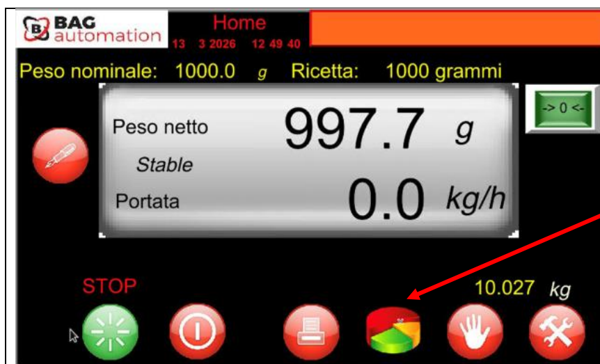
Fig. 13 Schermata standard in cui è visibile il tasto per l'accesso alla pagina statistica (pag.3). Standard screen showing the button to access the statistics page (page 3)
